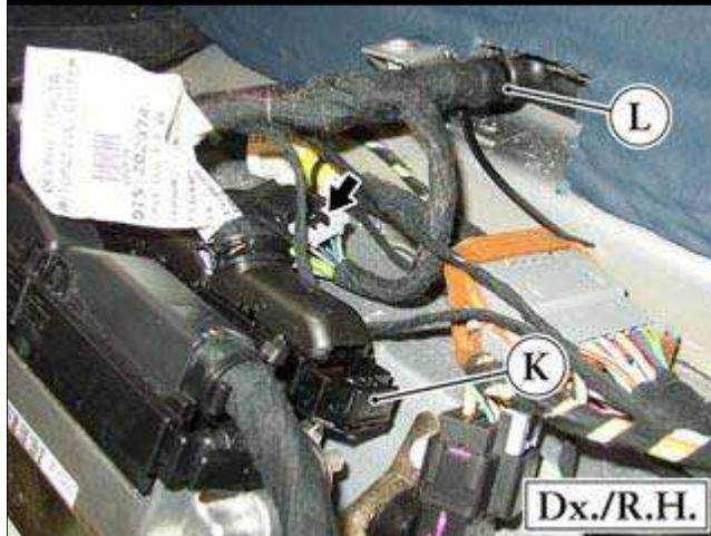
● 从右侧 Motronic ECU 拆卸发动机侧插头 (K) 和箭头指示的插头。
