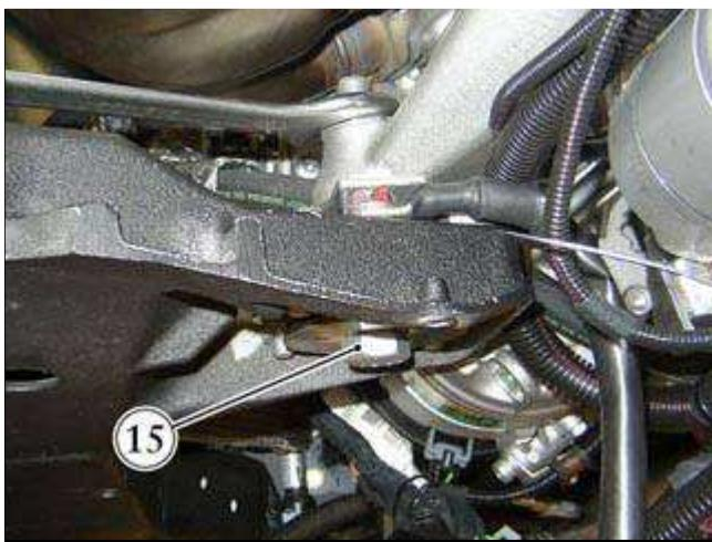
● 松开将发动机固定架固定到底盘的螺母；从下方拆卸螺钉 **(15)** 及垫圈。
