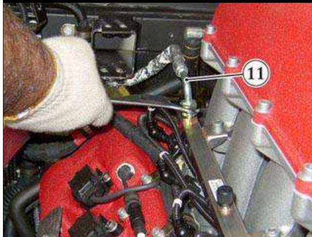
● 从喷油器油轨拆卸至喷油器的输送管 (11) 并将管路放置在不干扰后续操作的位置。
