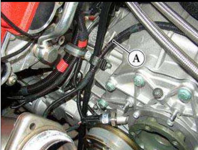
● 让机油蒸气分离器上的管和通向热交换器的机油管保持连接。
