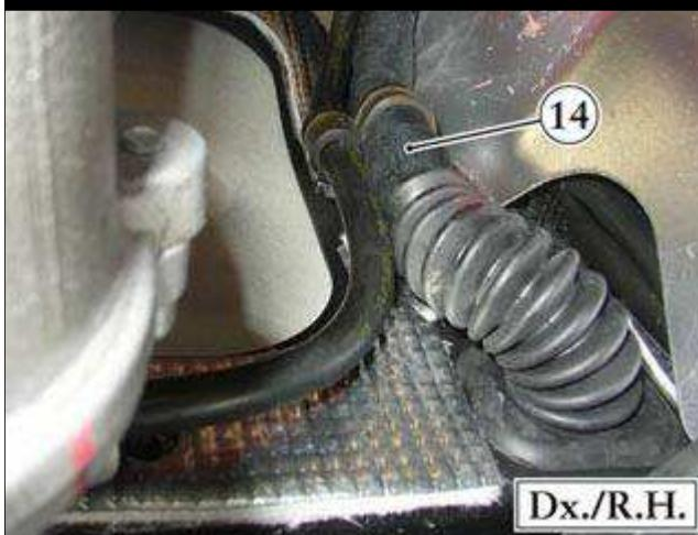
● 在车辆下方, 拆卸发动机检查盖旁边的电缆固定支架 (14)。
