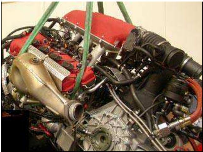
● 提起发动机前部并将其向后缓慢移动，确保它不接触底盘。
