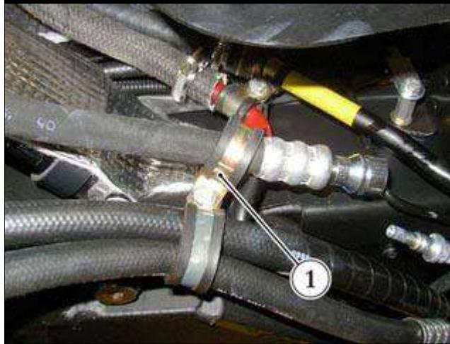
● 松开将液压转向泵管紧固到底盘的夹子 (1)。
