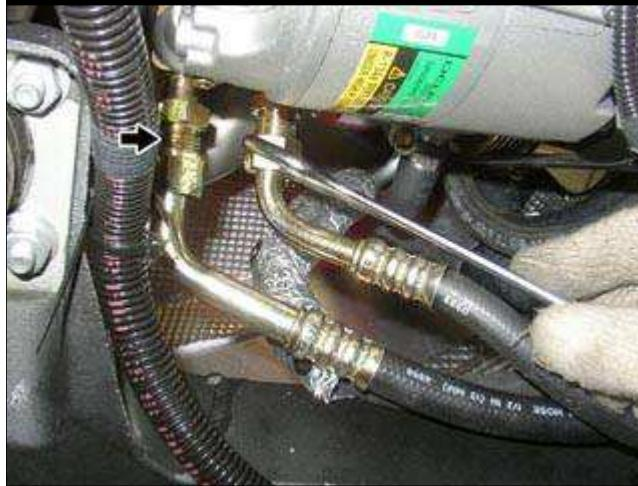
● 从压缩机分离空调系统的管接头。
