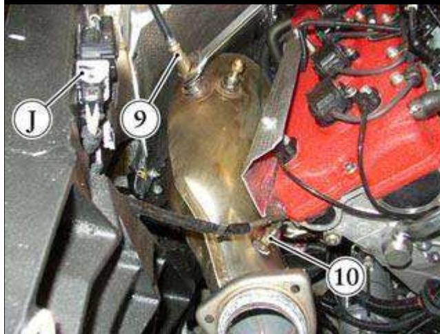
● 从各个排气歧管拆卸氧传感器 (9) 和热电偶 (10): 也从底盘拆卸接头 (J) 并将其放置在车外。
