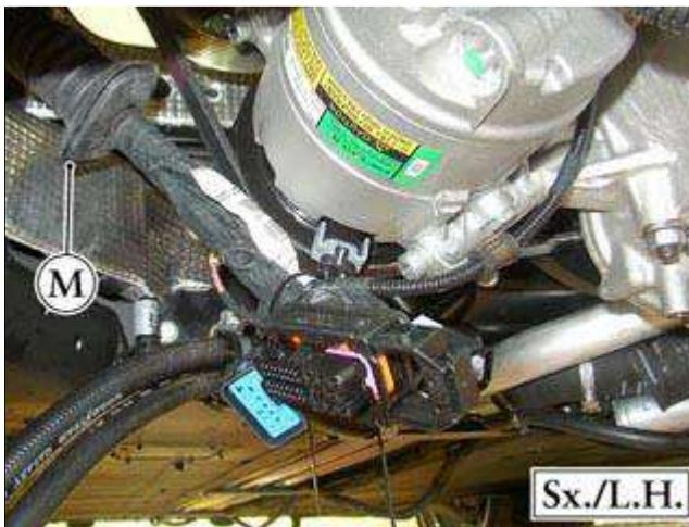
● 从隔壁拆卸电缆垫环波纹管 (M) 并集中电缆, 将其固定到发动机上, 使其不会干扰拆卸。
